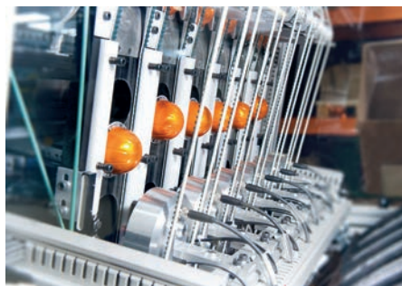
Jede Kapsel wird nach dem Tiefziehen automatisch auf Dichtigkeit geprüft.
